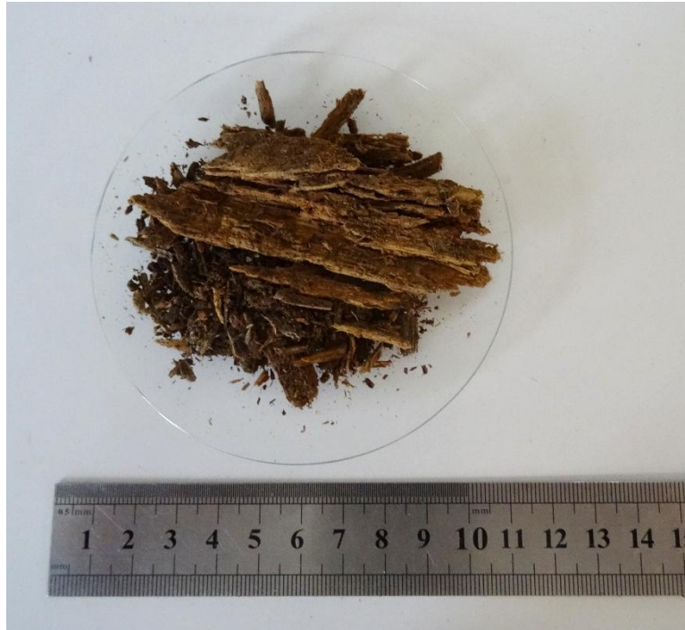
Bois présentant des dégradations
