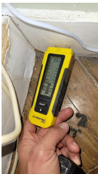
Chambre 01 (Plinthes) : Taux d'humidité 22%. Risque de développement de champignons lignivores.
