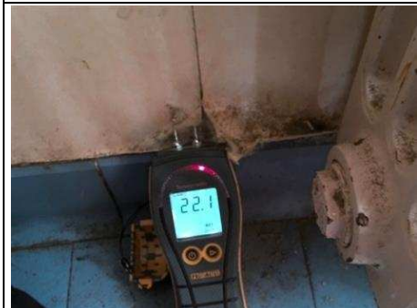
Photo n° PhTer011 Localisation : Rez de Chaussée - Cuisine Ouvrage : Mur - plâtre et papier peint et faïence Informations complémentaires : Hygrométrie de surface égale à 22,1 % Localisation sur croquis : 011
