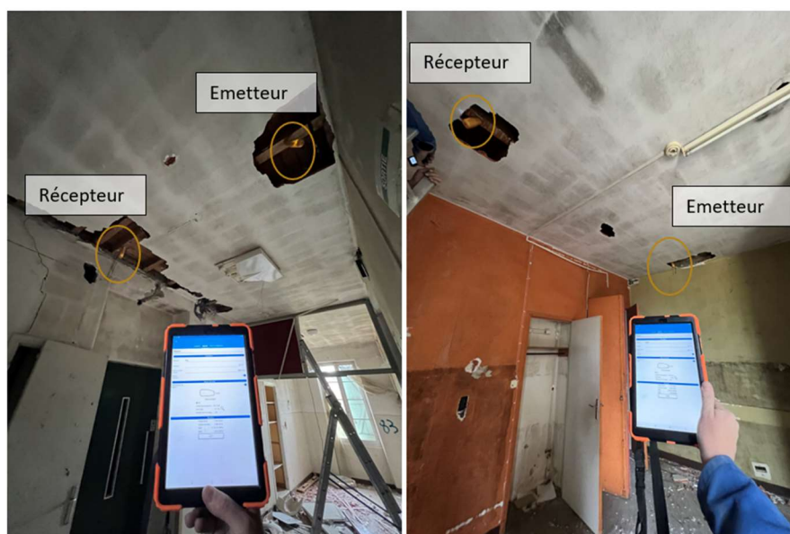
Photographie d'essai d'auscultation sonore
